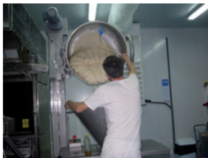
Figura 46.- Máquinas que obligan a adoptar posturas forzadas de brazos.
